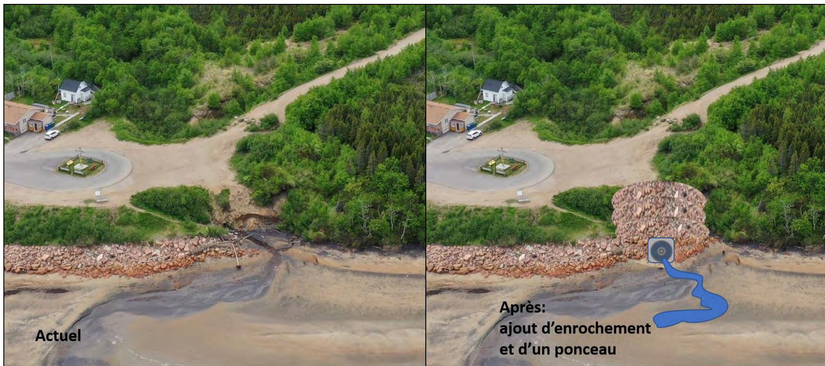
Figure 111. Deuxième solution d'adaptation proposée pour le secteur du tuyau pluvial – Enrochement de la falaise active et ponceau à l'intérieur de l'ouvrage.
