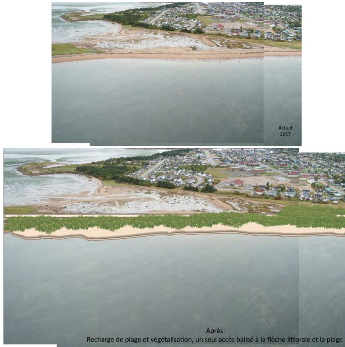
*Figure 117. Solution d'adaptation proposée pour le secteur de la flèche et de la terrasse de plage – Recharge de plage et végétalisation en limitant l'accès à la plage avec un sentier balisé derrière la recharge.*
