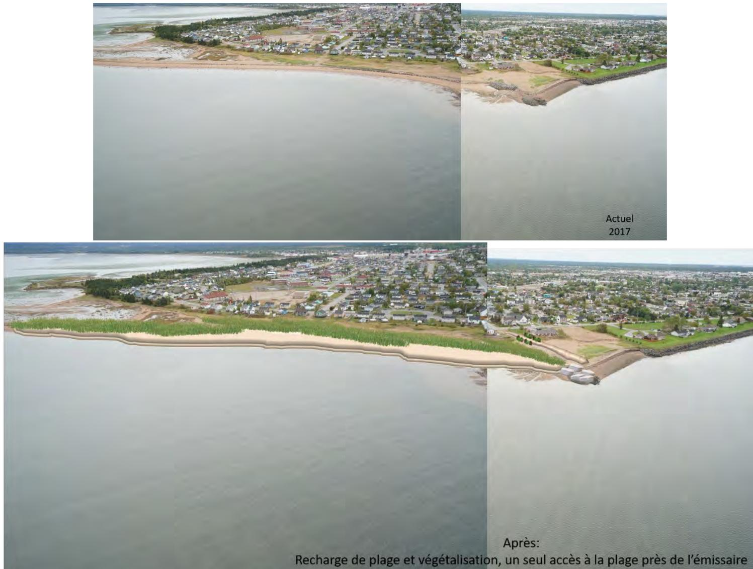
Figure 116. Solution d'adaptation proposée pour le secteur de la flèche littorale et de la terrasse de plage – Recharge de plage et végétalisation en limitant l'accès à la plage avec un sentier balisé à l'est de l'émissaire.
