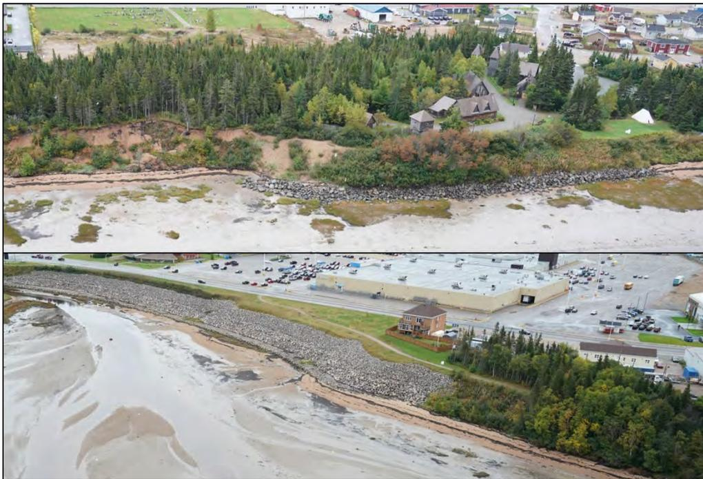
Figure 73. Bâtiments exposés à l'érosion le long de la falaise meuble (photos obliques hélicoptères 2017). La photo du haut : site patrimonial du Vieux-Poste et la photo du bas : Immeuble à logement Aussi protégé par un enrochement dans la falaise meuble.
